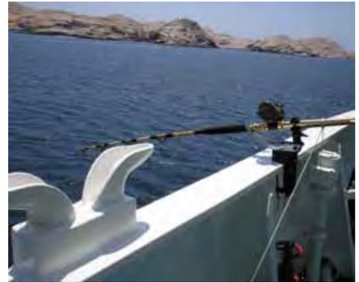
Figura 7-. Calibración de la ecosonda a través de una esfera de cobre. Cada frecuencia tiene su propia esfera.
