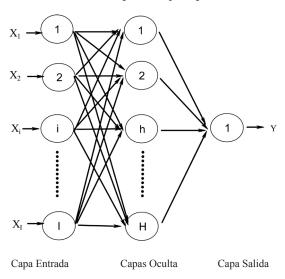
**Fig. 3.** Arquitectura de una Red Neuronal Artificial (RNA). Las flechas son las interconexiones entre las capas de entrada, oculta y salida. X son las variables predictoras, Y es la variable predictante y H es el número de nodos en la capa oculta.
