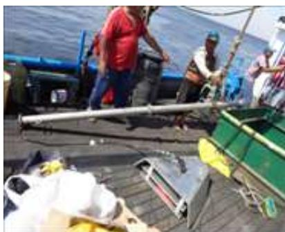
Figura 1: Montaje y ensamblado del protector de transductor a la borda de IMARPE V, parte del ecosonda científico
